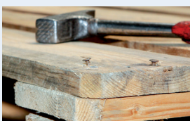
A kismértékben kiálló szegek lekalapálása.
